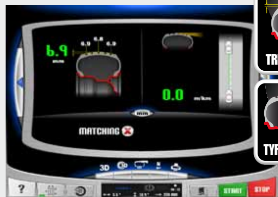
Profondità battistrada e deriva della ruota Tread depth and wheel drift
