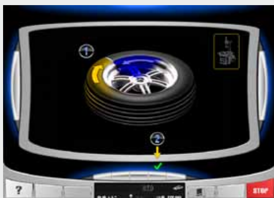
Eccentricità radiale e laterale della ruota Radial and lateral wheel run-out
